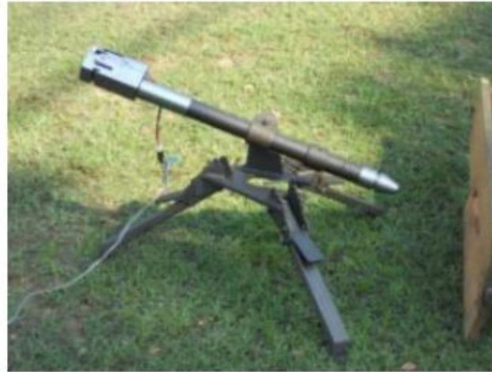
รูปที่ 1: ปืนน้ำแรงดันสูง (ซ้าย) เมื่อประกอบกับหุ่นยนต์ควบคุมระยะไกล และ (ขวา) เมื่อประกอบกับขาตั้ง
